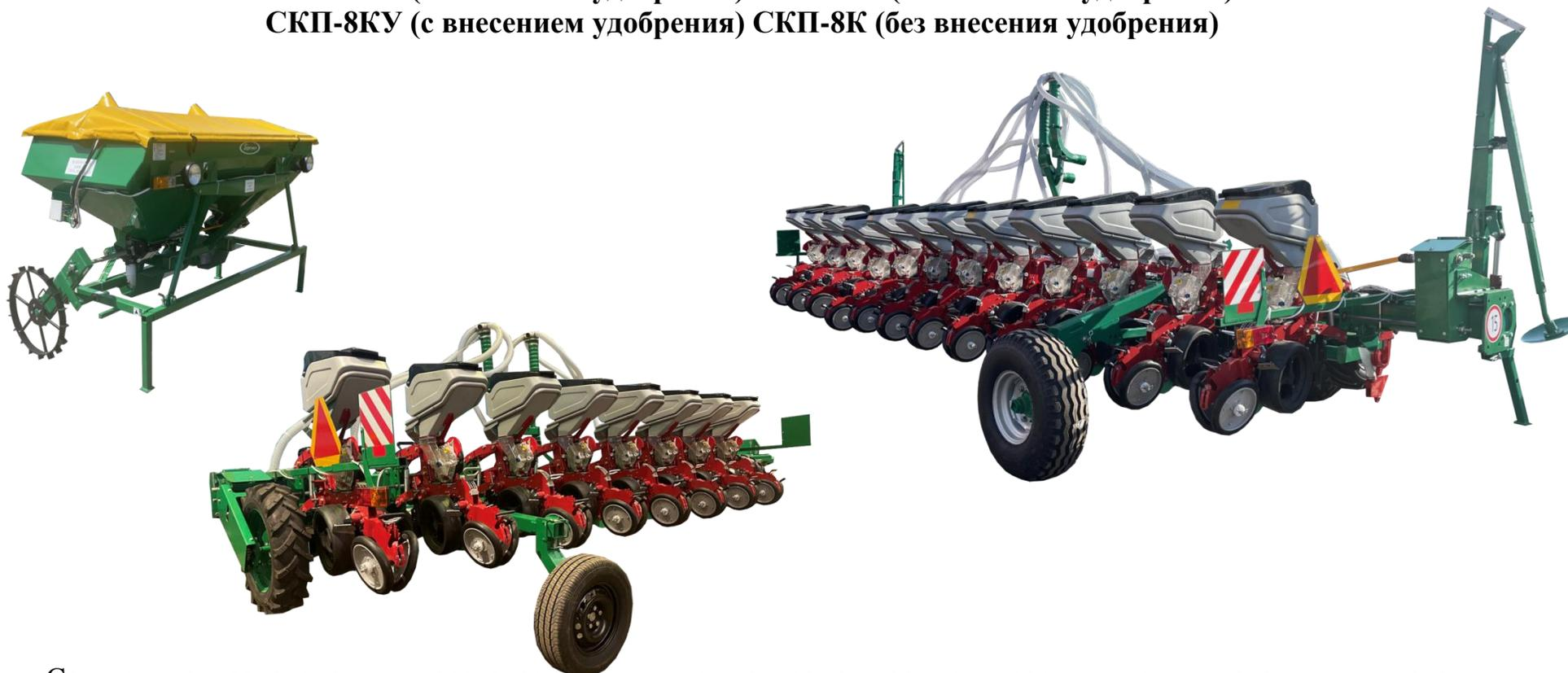
Сеялка предназначена для посева семян кукурузы с возможностью внесения гранулированных минеральных удобрений (в номенклатуре присутствуют машины без внесения удобрений). Комбинация машины включает в себя бункер удобрений на передней навеске трактора (в версии с возможностью внесения удобрений) и посевную шину с высевальными секциями на задней навеске трактора.
